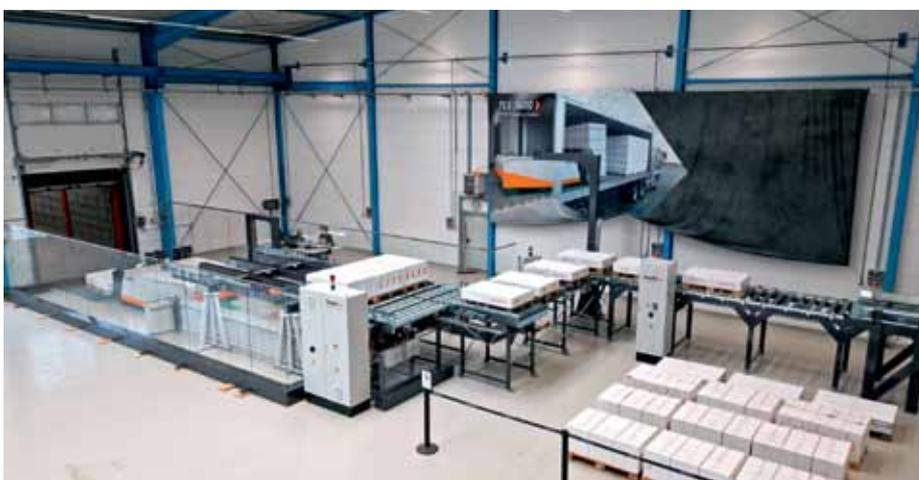
Geringer Platzbedarf für das automatisierte Be- und Entladen: Gesamtlänge der Ladezone rd. 14 m inklusive 3 m Rangierdistanz.
