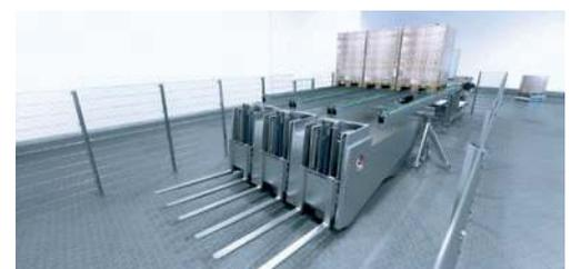
› Der TRAPO Loading Mover nimmt das TLS auf, verfährt und positioniert es an der Rampe.
