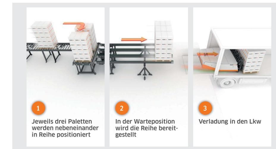
\* Beim One-Shot-Loading wird zunächst die gesamte Palettenfracht eines Lkw vor der Ladeluke durch Gabelstapler auf Förderrollen bereitgestellt, um sie in einem Zug zu verladen. Voraussetzung ist ein fest installiertes Schienensystem – im Ladebereich und im Lkw.
