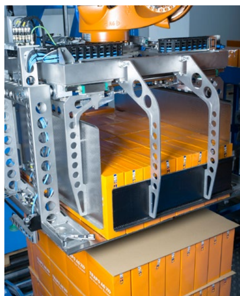
› Der Vakuumgreifer setzt die Zwischenlage auf.
