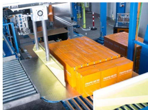
➤ Le poussoir couche pousse la couche complète sur le préhenseur
